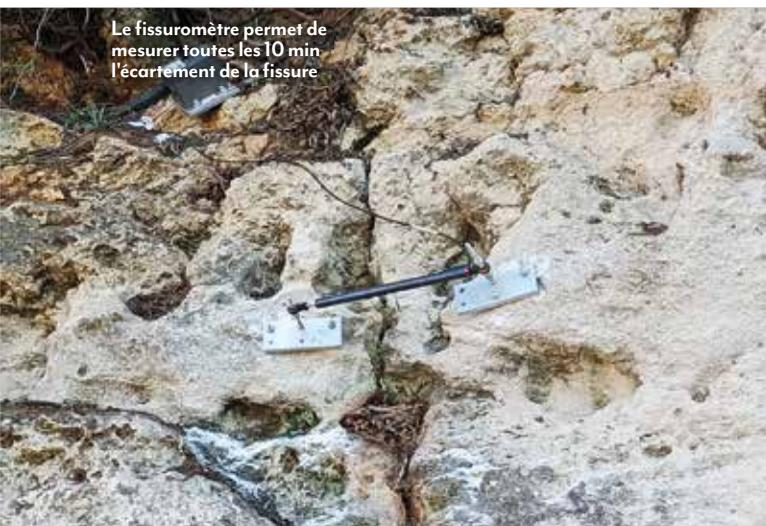
Le fissuromètre permet de mesurer toutes les 10 min l'écartement de la fissure
